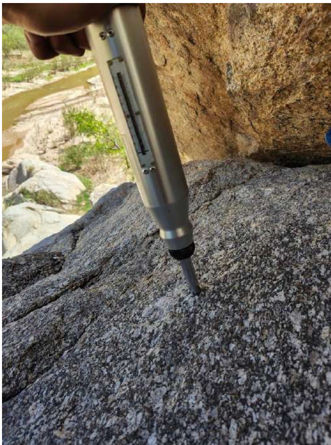
Fotografía 4.9 Ensayo in situ con Martillo de Schmidt
